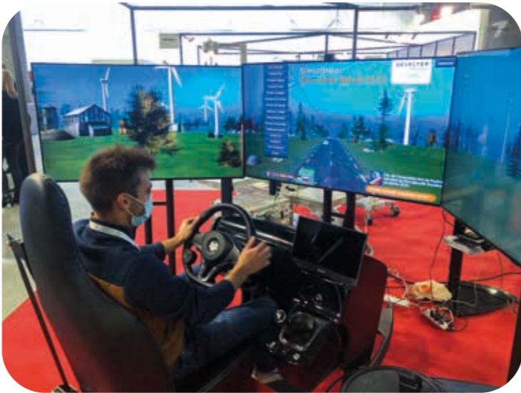
Simulateur de conduite Il reproduit un véritable poste de pilotage avec tous les éléments que l'on peut retrouver dans une voiture. Ce type d'appareil peut accepter des cercles ou boules de commandes se fixant sur le volant pour permettre son utilisation par des patients portant diverses pathologies. Couplé au travail d'un ergothérapeute, cet outil technologique permet au patient de tester ses capacités, et de mettre en évidence ses difficultés pour maximiser sa rééducation et à terme la reprise de son autonomie.
